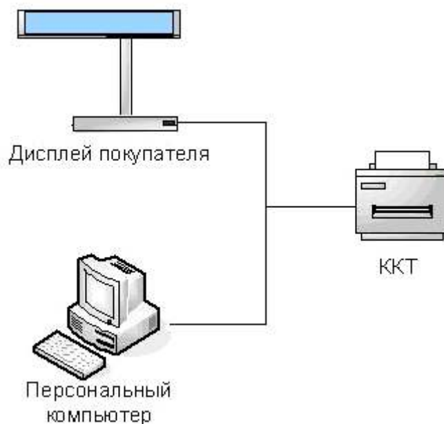
Рисунок 3. Подключение управляющих устройств к ККТ
